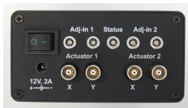
Abbildung 1: Linke Seitenplatte mit vier zusätzlichen „Adj-in“-Eingängen zur Verstellung der x und y Sollposition auf zwei PSDs
