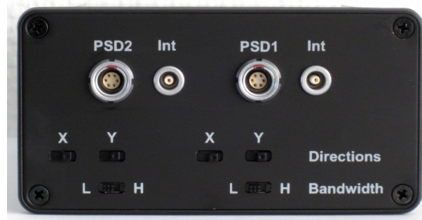
Abbildung 2: Rechte Seitenplatte der Controllerbox mit PSD-Eingängen und Intensitätsausgängen
