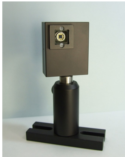
Abbildung 3: 4-Quadrantendiode für UV-Licht mit einer aktiven Fläche von 3x3 mm 2
