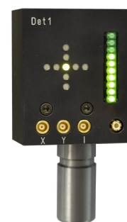
Abbildung 2: Detektor mit Positions- und Intensitäts-Anzeigen sowie Anschlüssen
