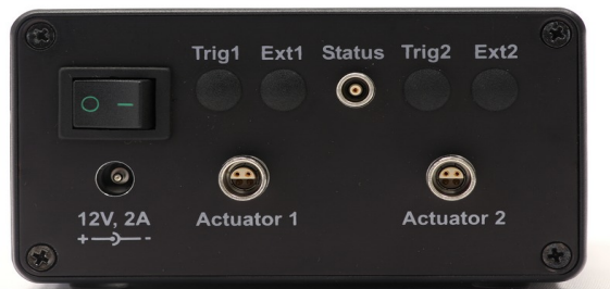
Abbildung 1: Einschalter, Netzteil-Anschluss und Ausgangsbuchsen links
