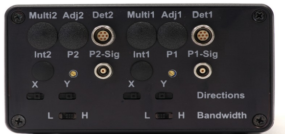
Abbildung 2: Eingangsbuchsen, P-Faktor-Einstellung und Schalter rechts
