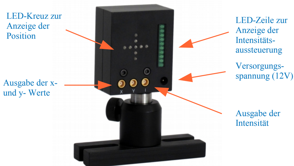
Abbildung 1: XYPSD mit Anzeigen und Ausgängen für Intensität und Position
