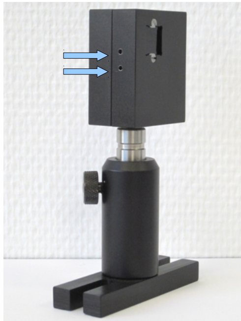
Abbildung 4: PSD-Detektor. Die Pfeile zeigen auf die Taster der Digital-Potentiometer zur Intensitätsaussteuerung (mit beiliegendem Metallstift zu betätigen).
