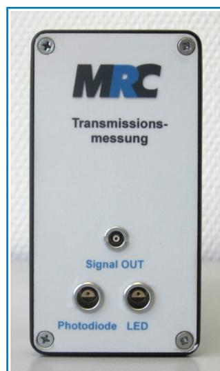
*Abbildung 5: Elektronik des Transmissions-Messsystems*
