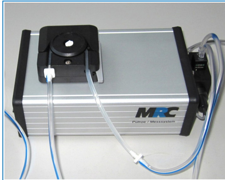
Abbildung 7: Schlauchpumpe Gemke LP60 am Gehäuse. Rechts ist die Messgabel mit Durchflussküvette angebracht, an die die Schläuche angeschlossen sind.
