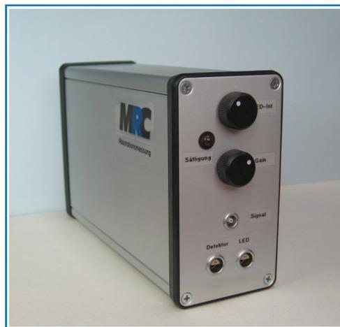
Abbildung 4: Elektronik des Transmissions-Messsystems
