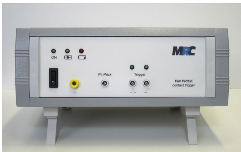
Abbildung 2: Elektronik für die Erfassung des Stimulationszeitpunkts (1 Kanal)
